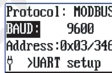
Fig. 6-14 Configuration du port série
